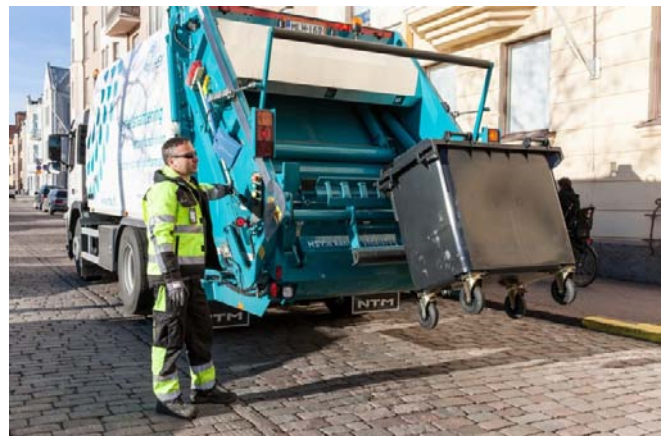
Kuva X. 660 litran jätēsäiliö tyhjenetään koneellisesti jäteautoon.
